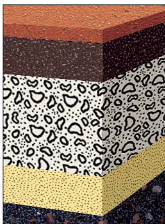
Schichtaufbau eines geodur-Tennisplatzes
